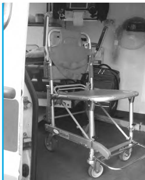
Brak mocowania dla krzeselka kardiologicznego. Sprzęt ten nie nadaje się do przewożenia pacjentów w ambulansie (fot. I. Riczka)
