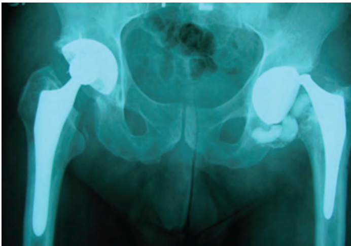
Ryc. 29. Rozkawałkowanie ceramicznej głowy endoprotezy i wytarcie konusa, na którym była osadzona
