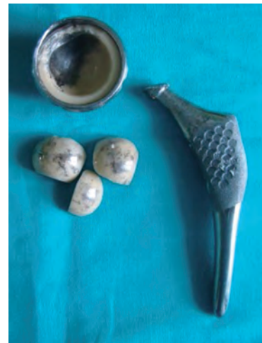
Ryc. 29. Rozkawałkowanie ceramicznej głowy endoprotezy i wytarcie konusa, na którym była osadzona
